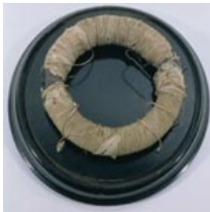
Figura 4 – O primeiro transformador feito por Faraday em 1831.
