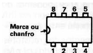
Fig. 11-1 — Ligações dos pinos do C.I. 555, vistas de cima, em encapsulamento tipo 'duplo em linha'.
