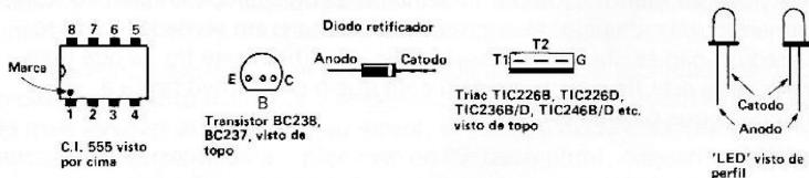
Fig. IX-8 — Identificação dos terminais dos semicondutores utilizados na montagem do interruptor por toque com autodesativamento automático.
