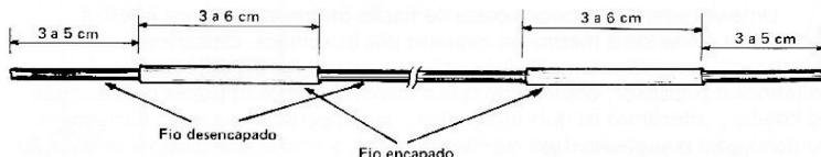
Fio encapado Fig. VII-7 — Confeção do "labirinto" a partir de um pedaço de fio rígido (encapado), de bitola não superior a 14 AWG.
