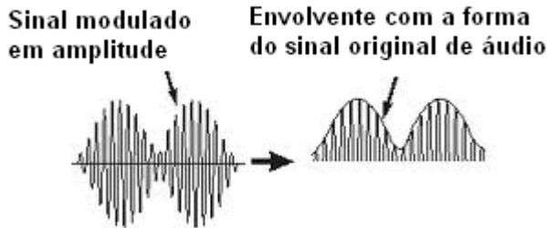
Figura 17 – Detecção do sinal modulado em amplitude
