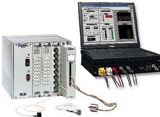
Figura 11 – Sistema de condicionamento de sinais para sensores LVDT.
