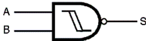
Figura 11 – A função NAND disparadora do 4093 (CMOS)
