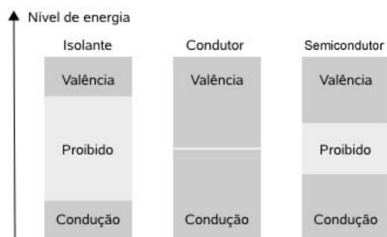
Figura 3 - As bandas conforme os materiais
