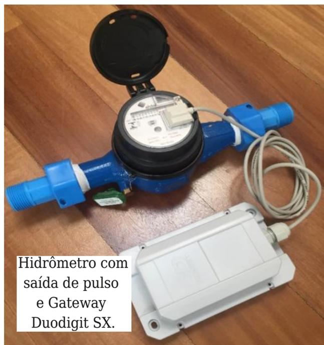
Hidrômetro com saída de pulso e Gateway Duodigit SX.
