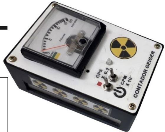
Este artigo propõe aos leitores o estudo de um contador Geiger experimental, explorando o funcionamento do tubo Geiger modelo M4011 com foco nos circuitos de polarização, detecção, medição e até mesmo interface simples para conexão com sistemas externos, como microcontroladores, arduíno ou circuitos digitais discretos.
