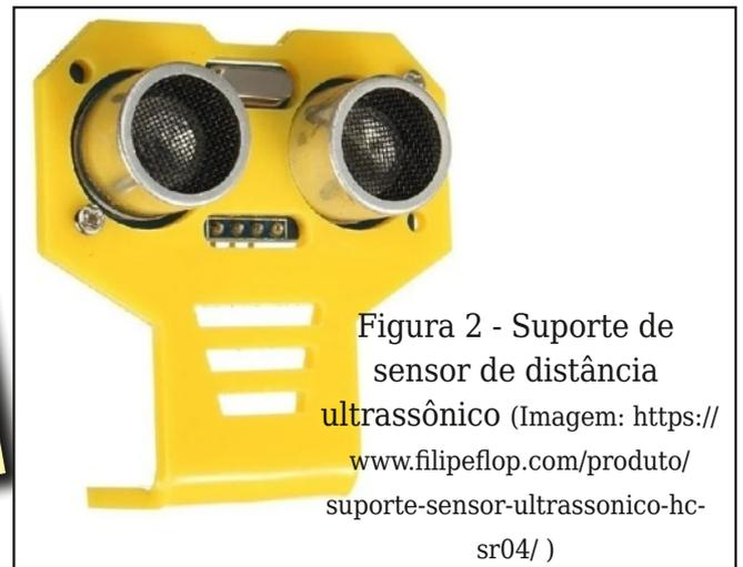
Figura 2 - Suporte de sensor de distância ultrassônico (Imagem: <https://www.filipeflop.com/produto/suporte-sensor-ultrassonico-hc-sr04/>)
