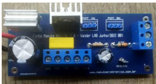
Figura 10 - Placa de regulação VL 01
