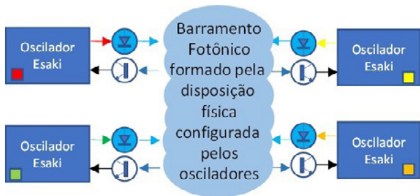
Figura 5. Diagrama eletrônico com 4 osciladores Esaki com acoplamento via barramento.
