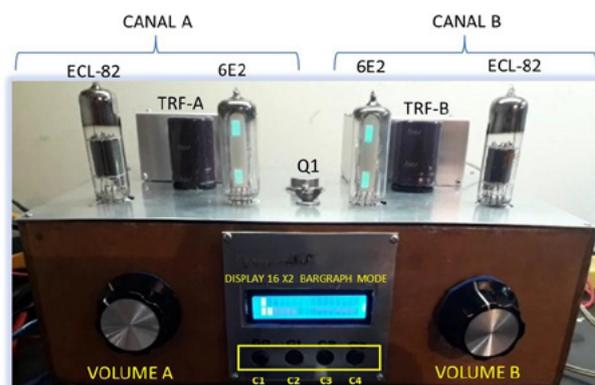
Figura 5 – Visão Externa do Amplificador PIC-ECL82
