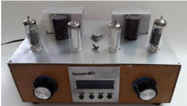
Figura 1 – Amplificador PIC-ECL82
