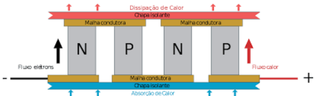
Figura 8 – Montagem do módulo
