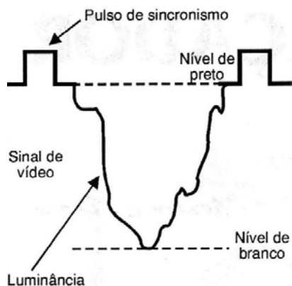
Figura 7 – O sinal de vídeo monocromático analógico
