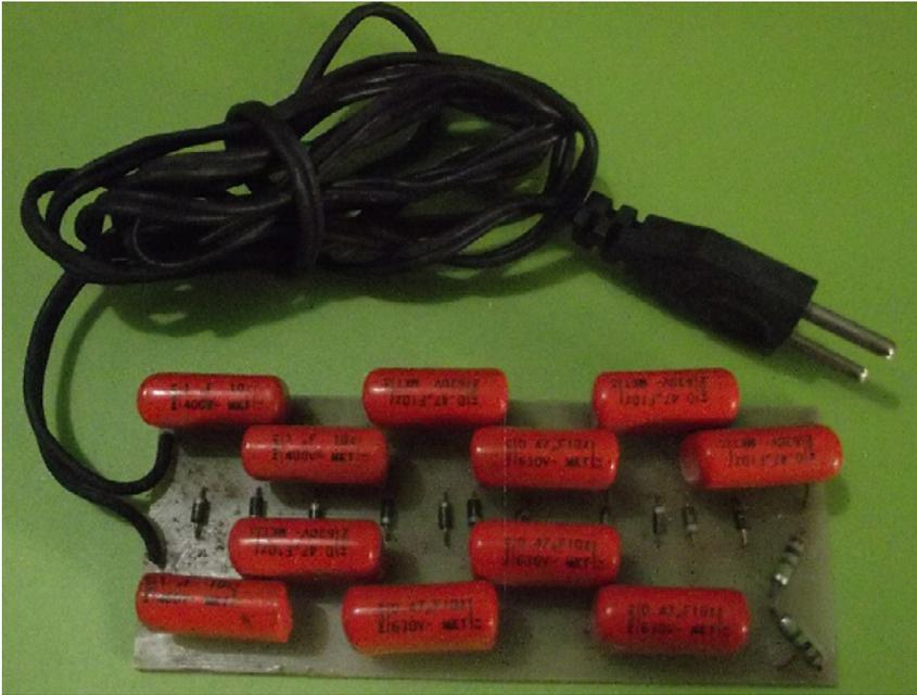
Figura 6 - Ionizador que montamos para conexão diretamente à rede de energia.
