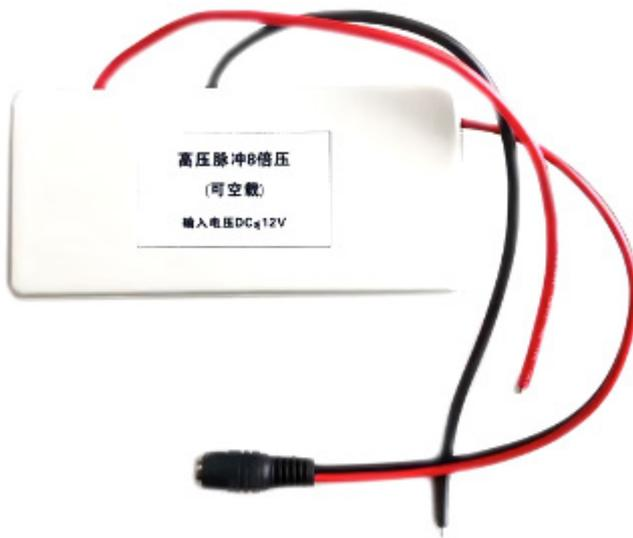
Figura 1 - Transformador para lâmpada neon decorativa
