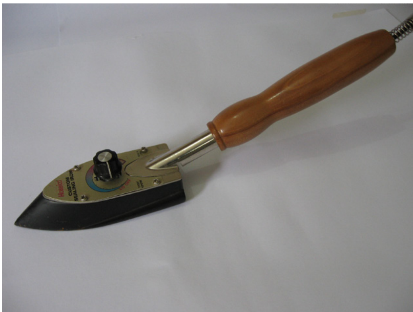
Figura 3 - Ferro para aplicação de plástico termo adesivo em aeromodelos
