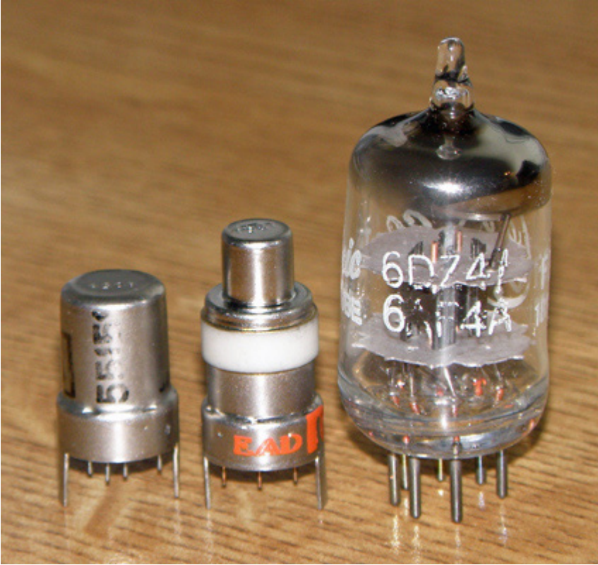
Figura 1 - Comparação de Tamanho: Nuvistor (6CW4) ao lado de válvulas miniatura de vidro para ilustrar a miniaturização extrema.
