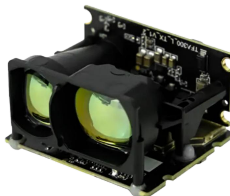
Figura 13 - O LiDAR TFA300-L da DFRobot
