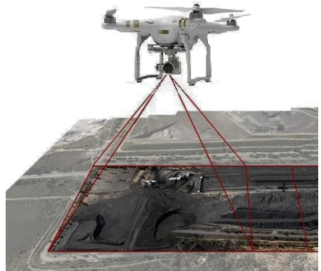
Figura 9 - Na aerofotogrametria são tiradas imagens processadas para se obter imagens 3D
