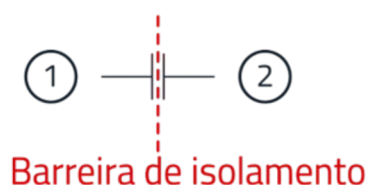
Figura 13 - Princípio de isolamento por capacitor.
