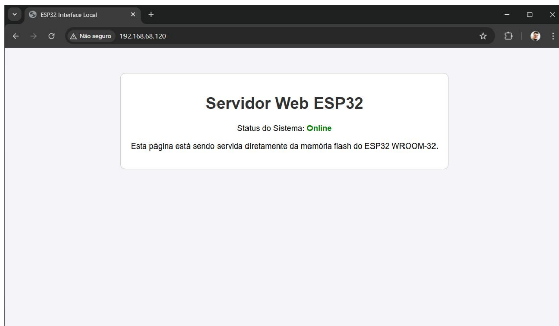
Figura 1 - Página web hospedada e servida de um ESP32, que contém um webserver embarcado nele.
