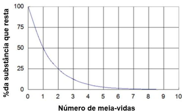
Figura 9 – Curva de decaimento de uma substância radioativa.
