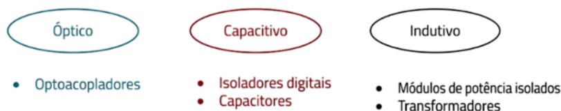
Figura 4 - Visão geral dos métodos de isolamento galvânico.
