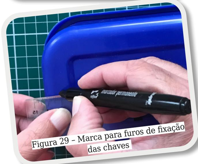
Figura 29 - Marca para furos de fixação das chaves
