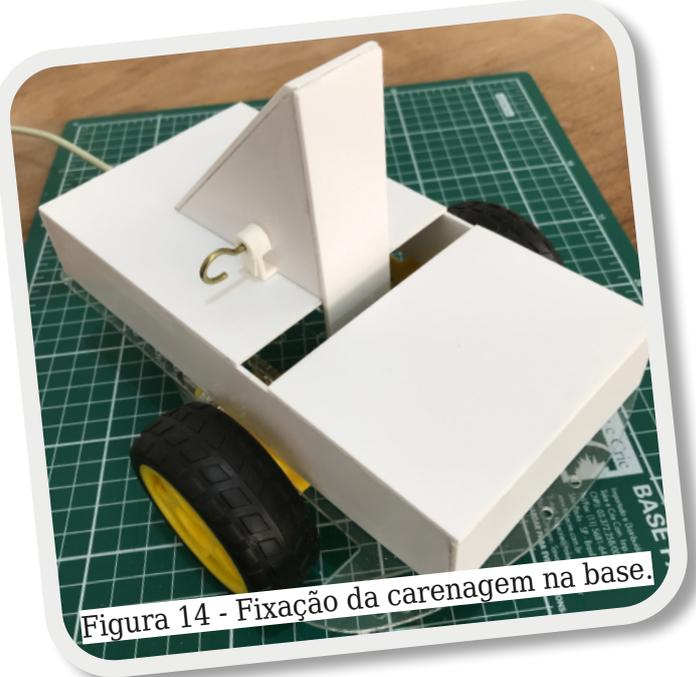
Figura 14 - Fixação da carenagem na base.
