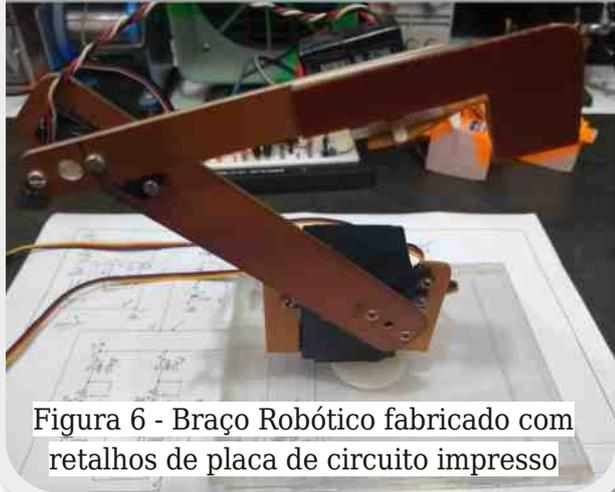
Figura 6 - Braço Robótico fabricado com retalhos de placa de circuito impresso
