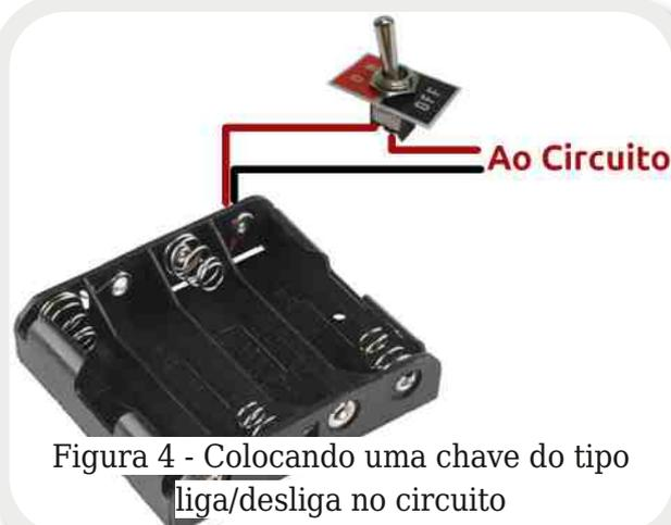
Figura 4 - Colocando uma chave do tipo liga/desliga no circuito
