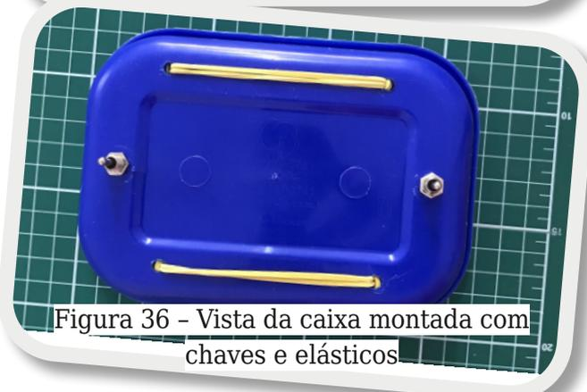
Figura 36 - Vista da caixa montada com chaves e elásticos
