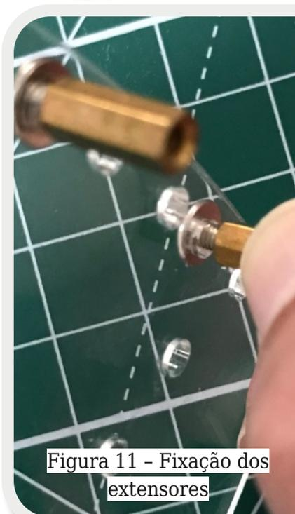
Figura 11 - Fixação dos extensores
