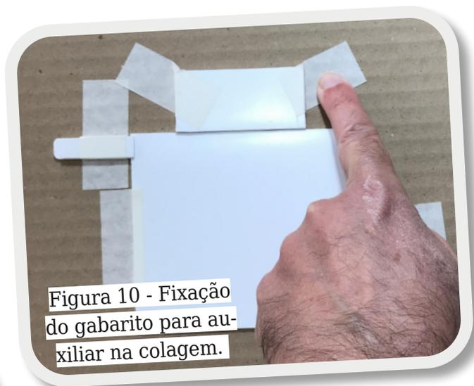
Figura 10 - Fixação do gabarito para auxiliar na colagem.
