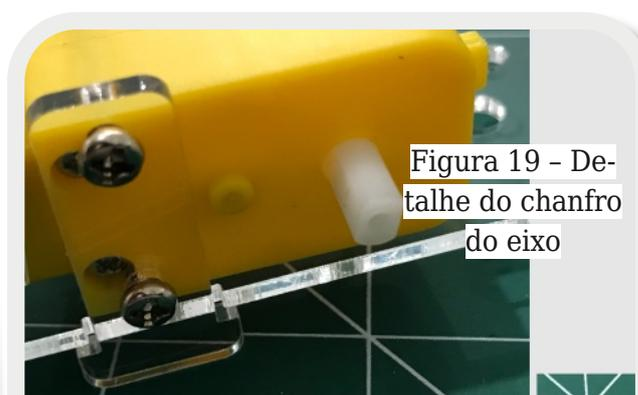
Figura 19 - Detalhe do chanfro do eixo
