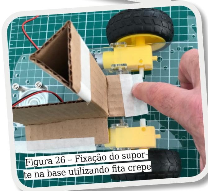
Figura 26 - Fixação do suporte na base utilizando fita crepe
