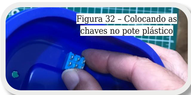
Figura 32 - Colocando as chaves no pote plástico
