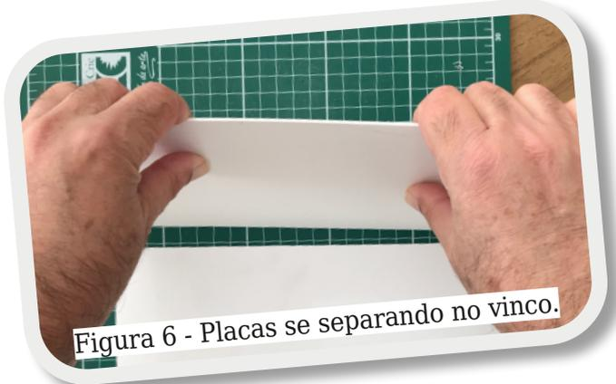
Figura 6 - Placas se separando no vinco.
