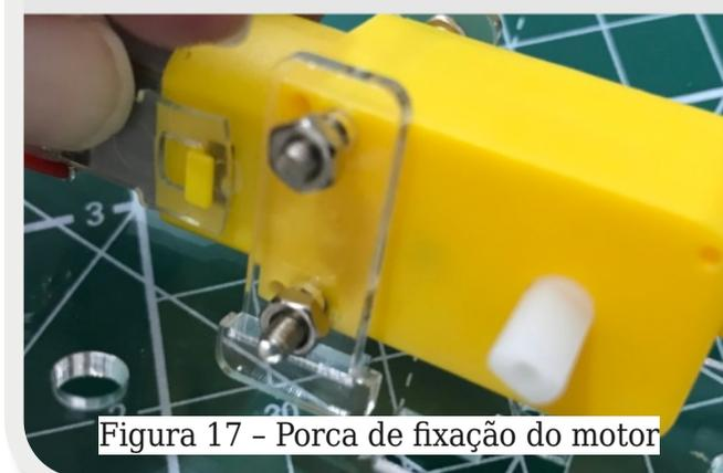
Figura 17 - Porca de fixação do motor
