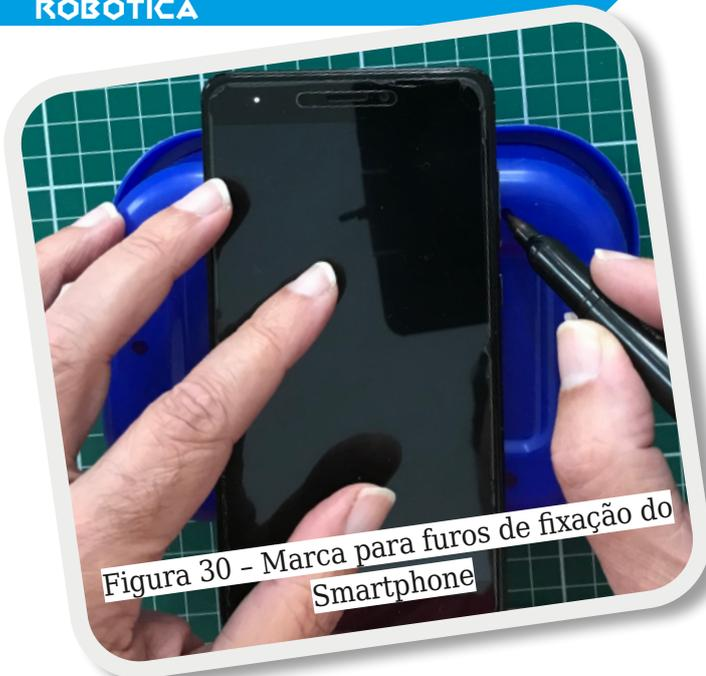
Figura 30 - Marca para furos de fixação do Smartphone
