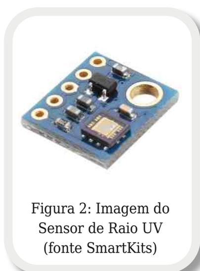
Figura 2: Imagem do Sensor de Raio UV (fonte SmartKits)
