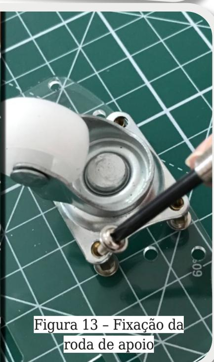
Figura 13 - Fixação da roda de apoio
