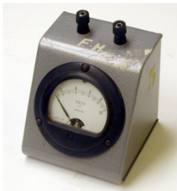
Figura 2 – Um Voltômetro
